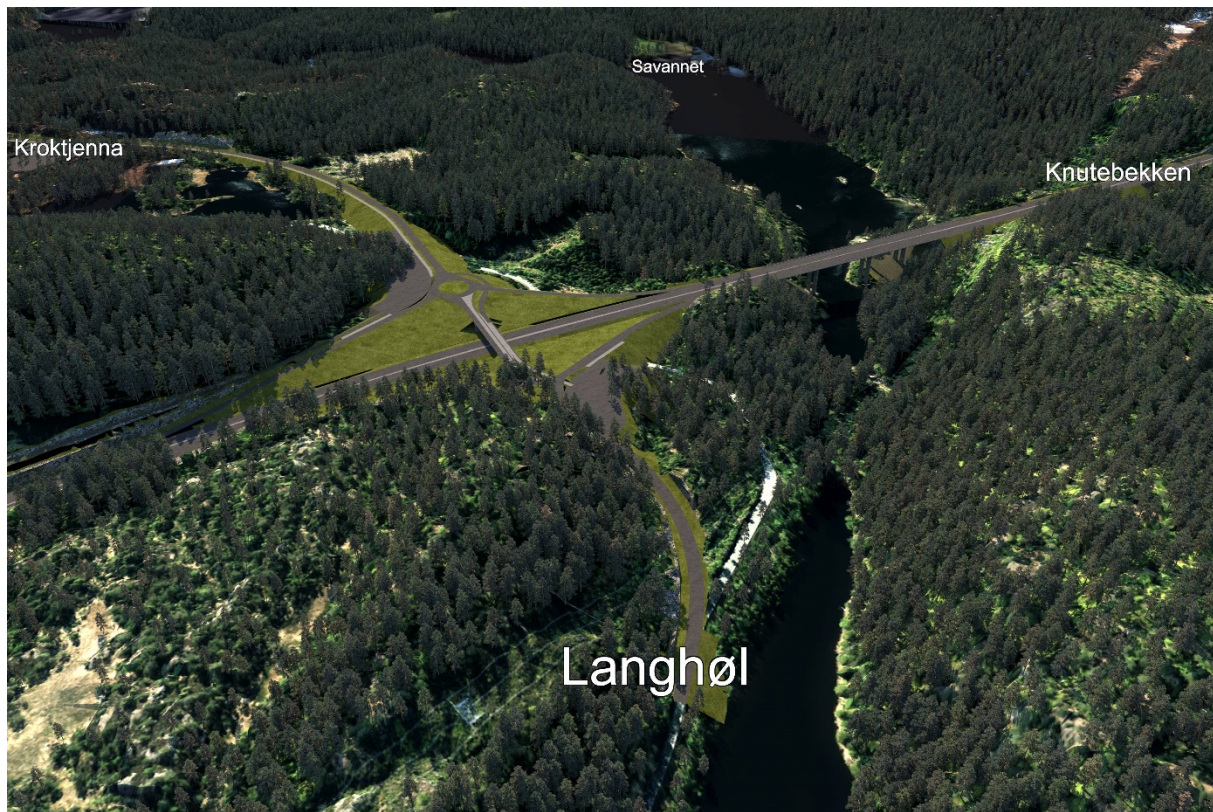
Figur 5-8 Nye E18 sett fra nord mot sørøst. Planlagt ruterkryss ved avkjøring til Risør fra ny E18 ved Rundholt/Savannet.
